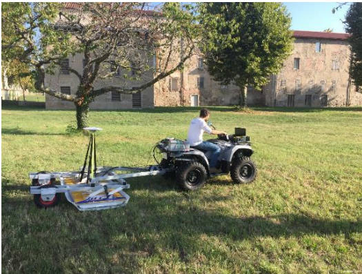
Géo-radar 3D multi-antenne à saut de fréquence Kontur (C. NORGEOT – MDS)
